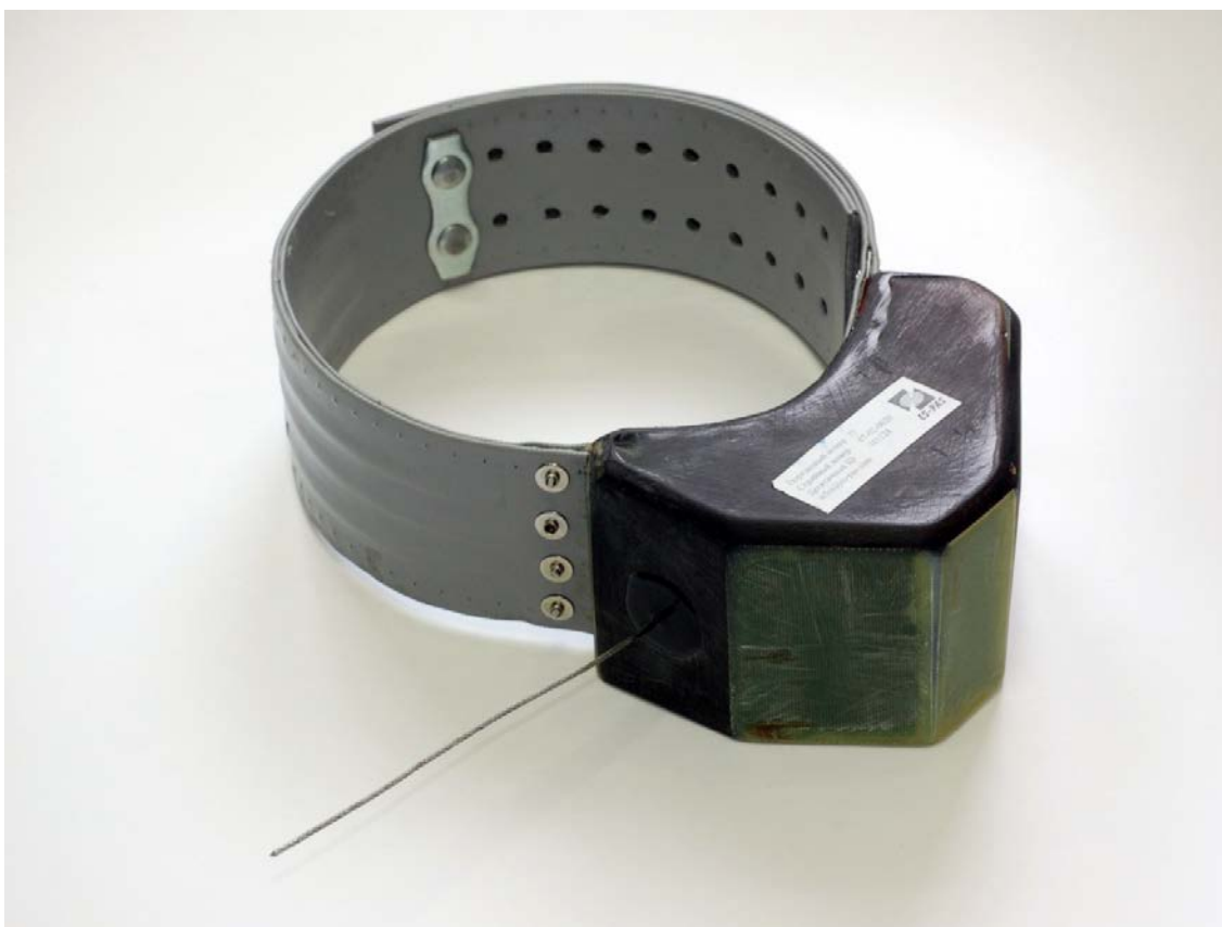
Рис. 34. Первый российский опытный экземпляр радиомаяка Argos для мечения копытных животных (производства ЗАО «ЭС-ПАС», 2010 г.).
