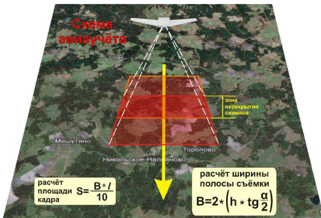
Рис. 193. Принцип авиаучёта диких копытных животных с применением беспилотного летательного аппарата.
